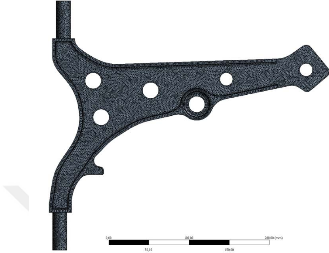
Şekil 6.3 Salıncak kolunun çözümleme modeli mesh yapısı
