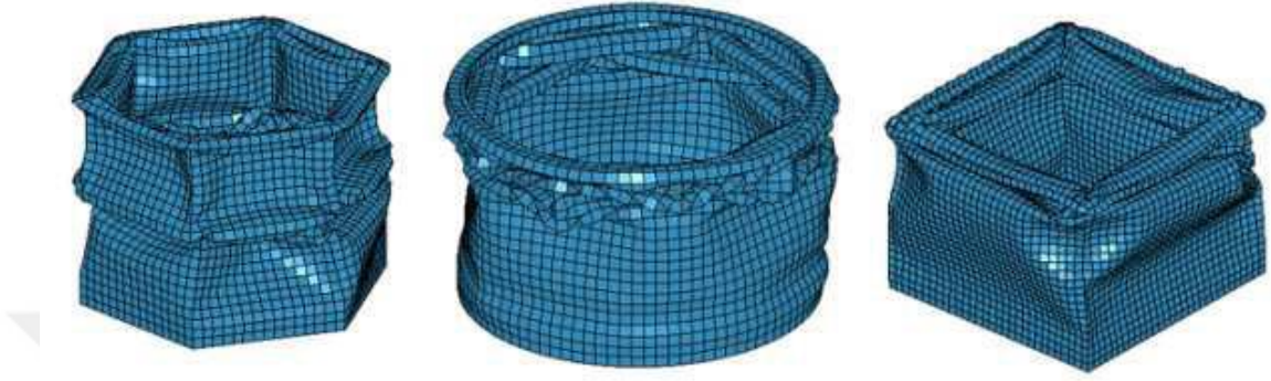
Şekil 3.3 Deforme olmuş altıgen, dairesel ve kare kesitli darbe emici geometrileri [5]
