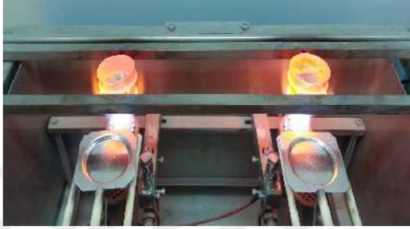
ekil 3.2.3 Eriti cihazında 1600 0 C' de eriti i lemne tabi tutulan numuneler
