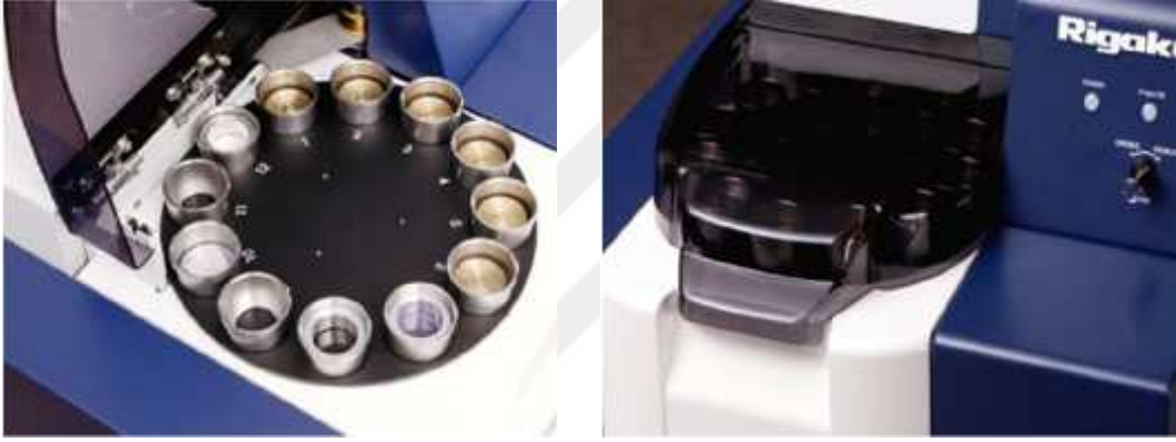
ekil 3.3.3 Rigaku Supermini 200 WDXRF numune de i tiricisi [56]
