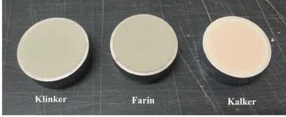
ekil 3.2.1 Valsi de irmende ö ütülen klinker, farin ve kalker numuneleri
