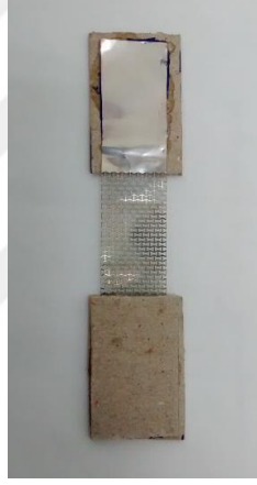
Şekil 5.1: Auxetic numunelerin çekme deneyi için hazırlanma sürecinden bir fotoğraf
