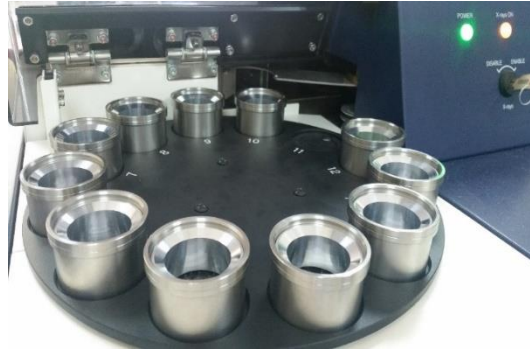
Şekil 3.8 Fe katkılı PS standart numune takımının WDXRF spektrometresine yerleştirilmesi
