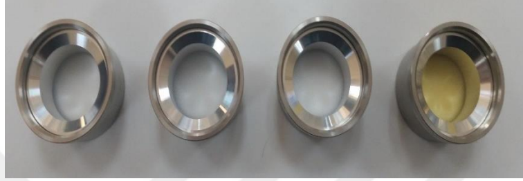
Şekil 3.1 WDXRF spektrometresinde analizleri için hazırlanan HDPE ve PP numuneleri
