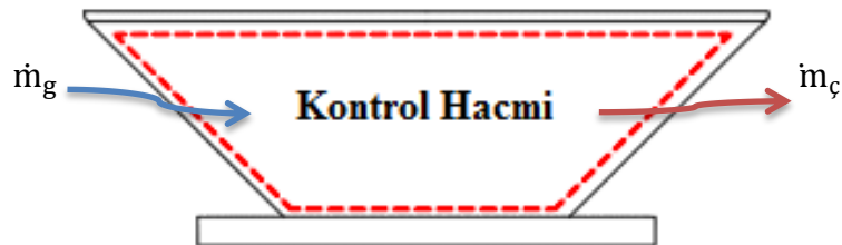
Şekil 3.5 Granülatörün kontrol hacmi olarak modellenmesi
