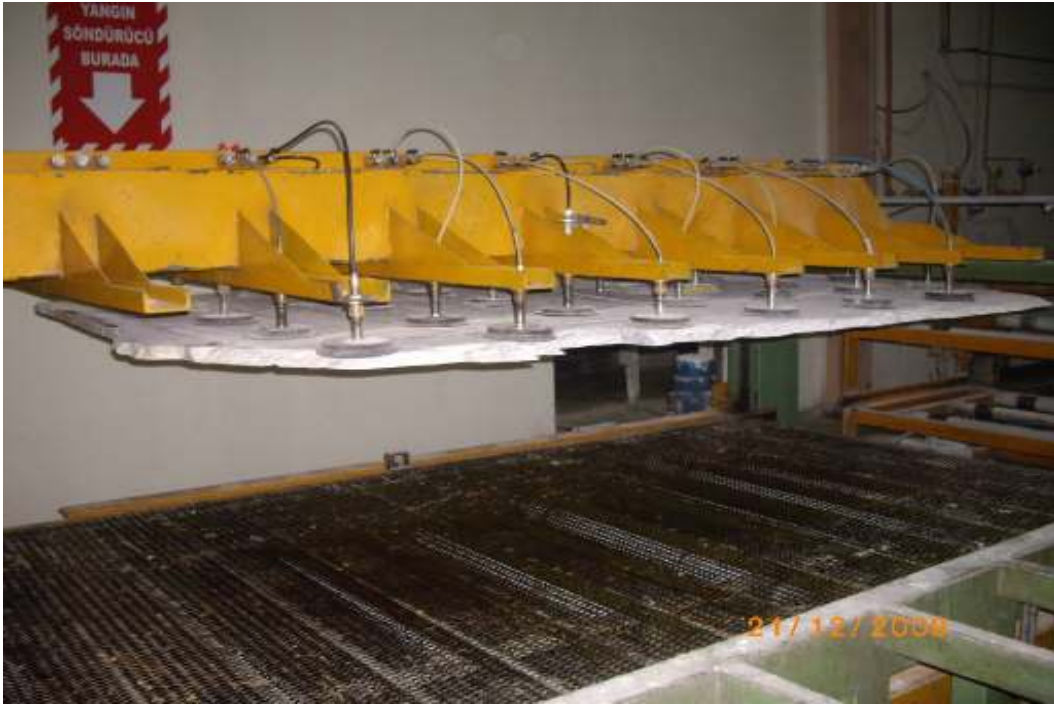
Şekil 3.17. Plakaların Robotlar İle Dolgu Makinesine Yükleneşmesi
