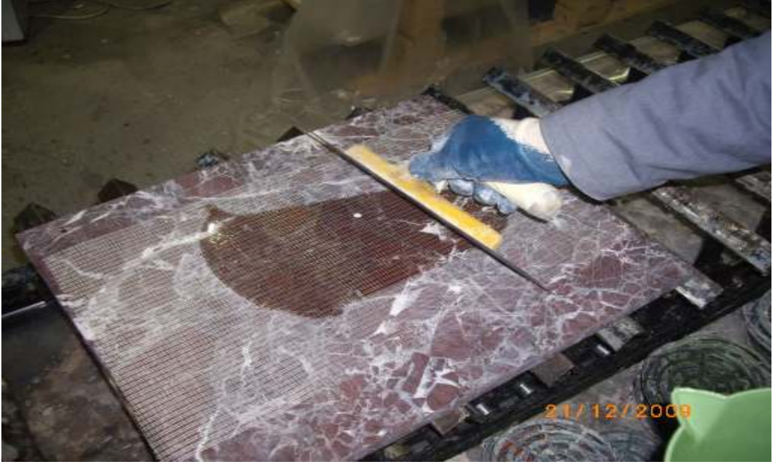
Şekil 3.20. Striplere Epoksi + Elyaf File Uygulaması
