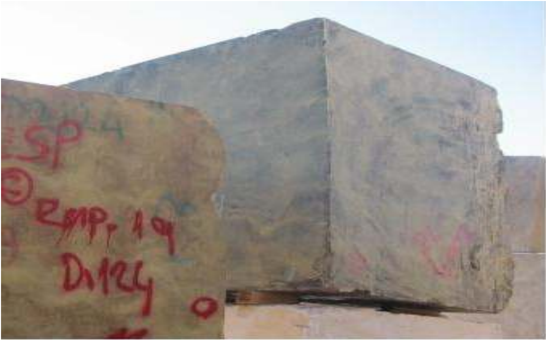
Şekil 3.9. Epoksi Jel İle Güçlendirilen Elazığ Vişne Bloğu
