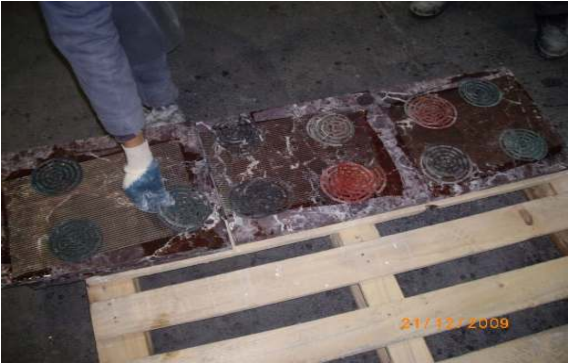
Şekil 3.21. Striplerin Aralarına Separatör Konularak Paletlere Dizilmesi
