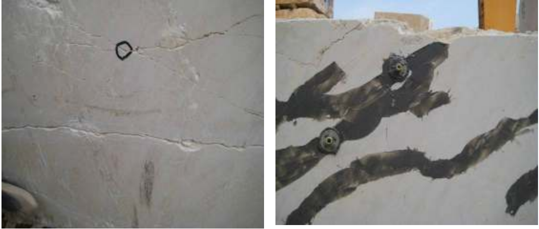
Şekil 2.4. Çin'de Bir Mermer Fabrikasında Uygulanan Blok Güçlendirme Yöntemi
