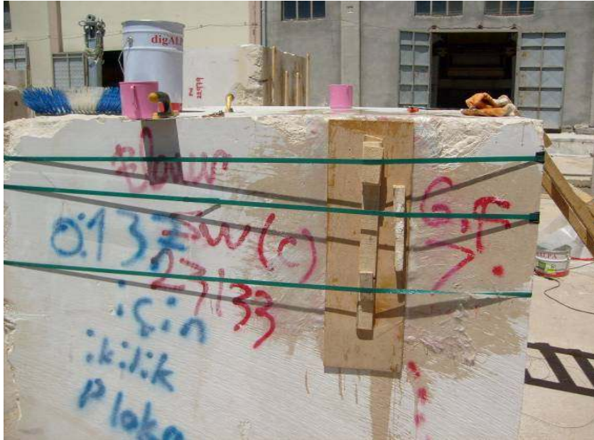
Şekil 3.15. Epoksi Jel İle Güçlendirilen Sand Wave Bloğu
