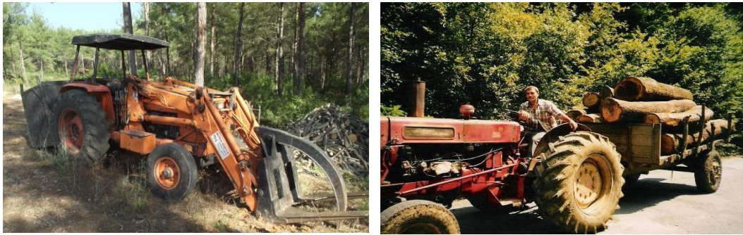
Şekil 1.4 Tarım traktörlerinin yükleyici (sol) ve taşıyıcı (sağ) olarak kullanılması
