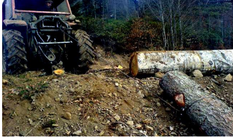
Şekil 1.3 Tarım traktörünün kablo çekimiyle asli orman ürünlerini çekmesi
