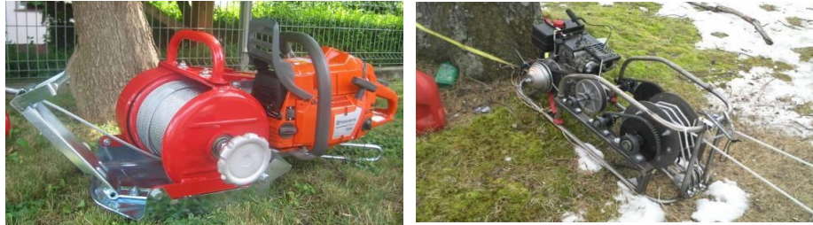
Şekil 1.6 ACKJA KBF 422 kablo vinç (sol) ve Radiotir kablo vinç (sağ)
