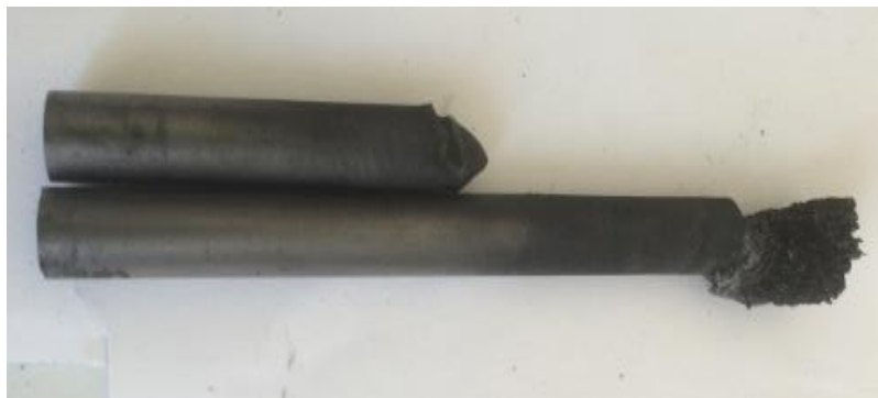
Şekil 34. Deney sonrası harcanan elektrot ve cüruf oluşumu
