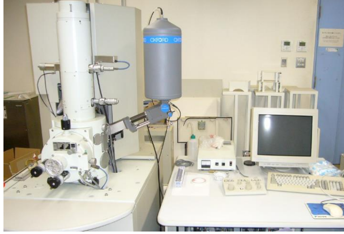
Şekil 38. İncelemenin yapıldığı JEOL JSM 6335F model SEM cihazının görüntüsü
