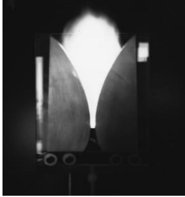
Şekil 8. Kayan ark oluşumunun yüksek hızlı kamerayla çekilmiş görüntüsü [22]
