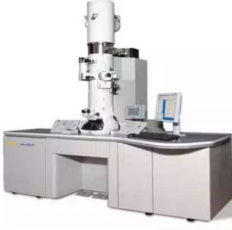
Şekil 39. İncelemenin yapıldığı JEOL JEM 2100 model HRTEM cihazının görüntüsü
