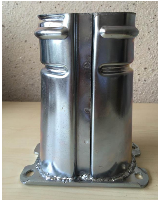
Şekil 5.98 Çarpışma testi sonucu oluşan durum (500 J)
