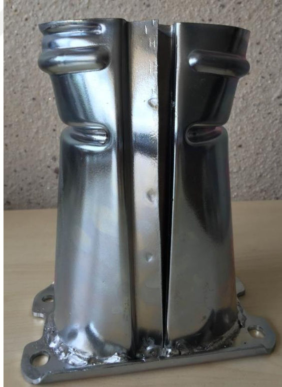
Şekil 5.100 Çarpışma testi sonucu oluşan durum (1250 J)
