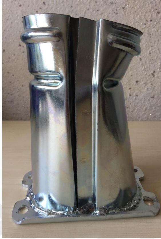
Şekil 5.101 Çarpışma testi sonucu oluşan durum (1500 J)
