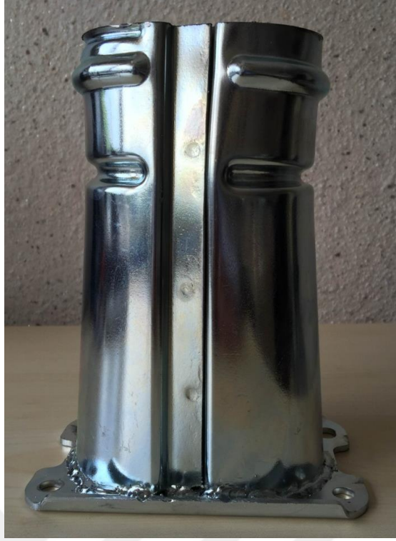
Şekil 5.99 Çarpışma testi sonucu oluşan durum (750 J)
