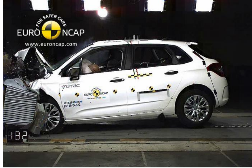
Şekil 1.2 Euro NCAP %100 önden çarpışma testi (Citroen C4) [3]
