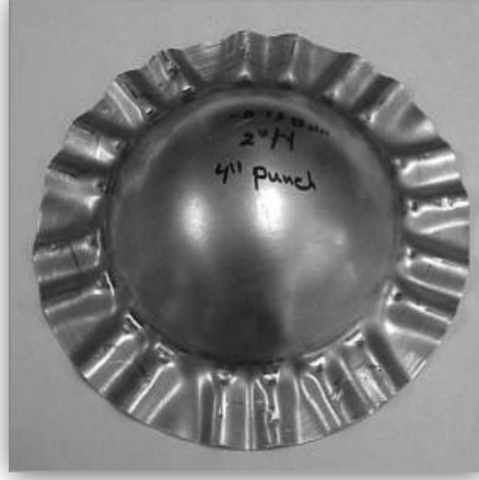
Şekil 3.2 Kalıpla temastan ve kesit değişiminden kaynaklı buruşma ve kırışma
