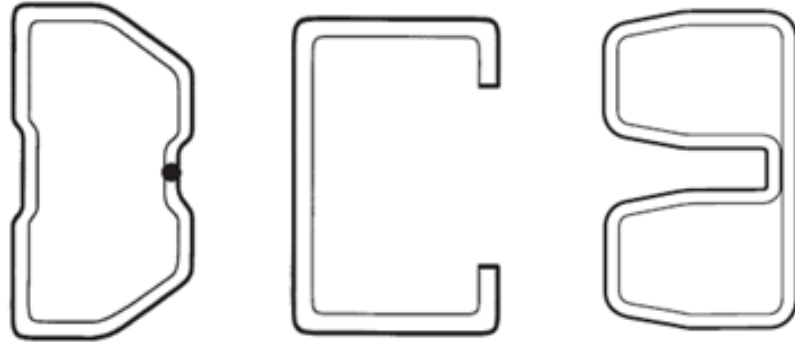
Şekil 2.3 Soğuk haddeleme yöntemiyle üretilen tampon profilleri [9]
