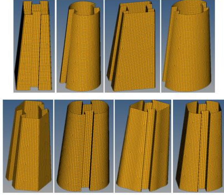
Şekil 5.15 8 farklı açılı-oluklu tip darbe emicilerin mesh görünümü
