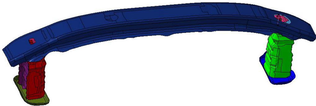
Şekil 5.1 Toyota Yaris araç modeline ait tampon ve enerji yutucu tasarımı
