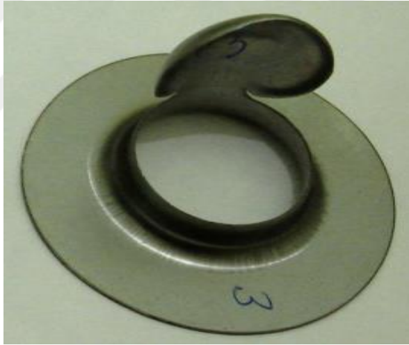
Şekil 3.1 Boyun vermiş ve kırılma maruz kalan bölge
