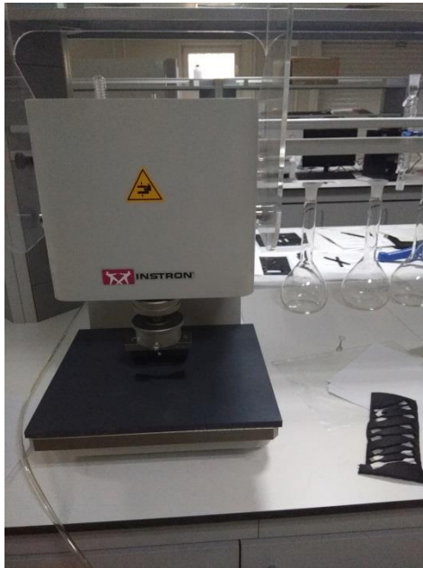
Şekil 3.1 Numune hazırlama makinesi (Instron 6054.000) ve hazırlanan numuneler
