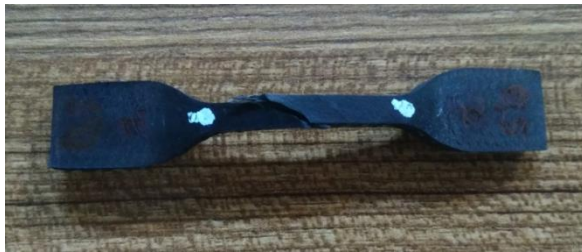
Şekil 3.3 0.5 mm/s hızda test edilen numunelerden birisi
