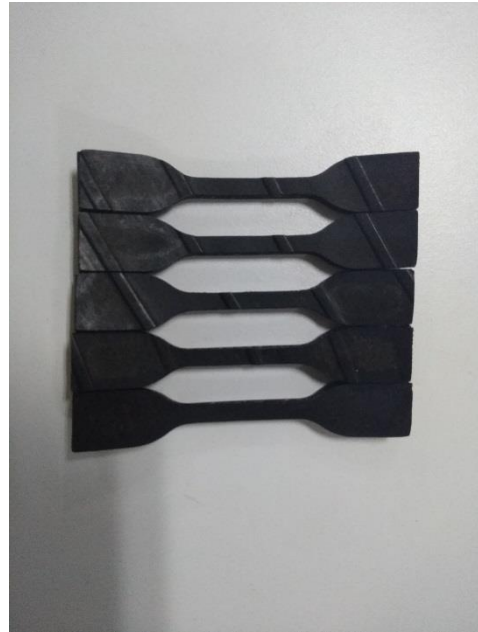
Şekil 3.1 Numune hazırlama makinesi (Instron 6054.000) ve hazırlanan numuneler
