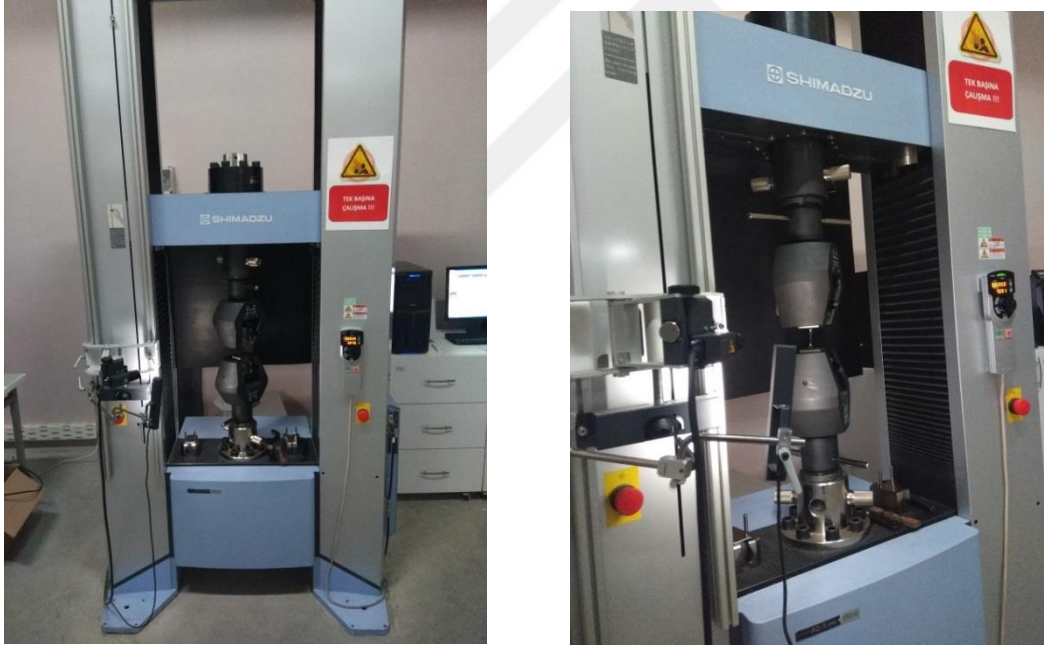
Şekil 3.2 Çekme testi makinesi (Shimadzu AG-X Plus 250 kN)
