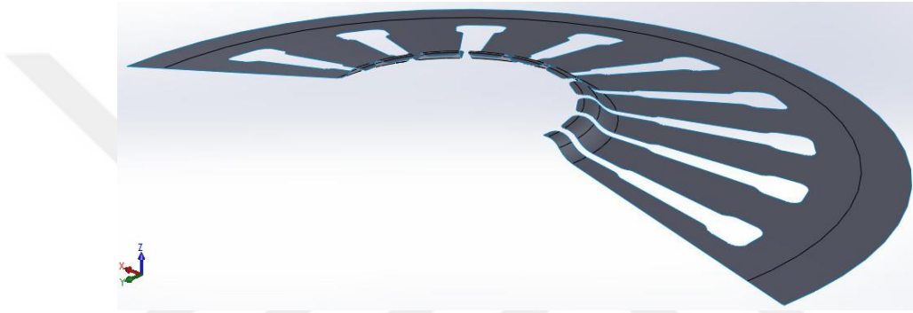
Şekil 4.3 : Diyafram yay yüzey modeli.
