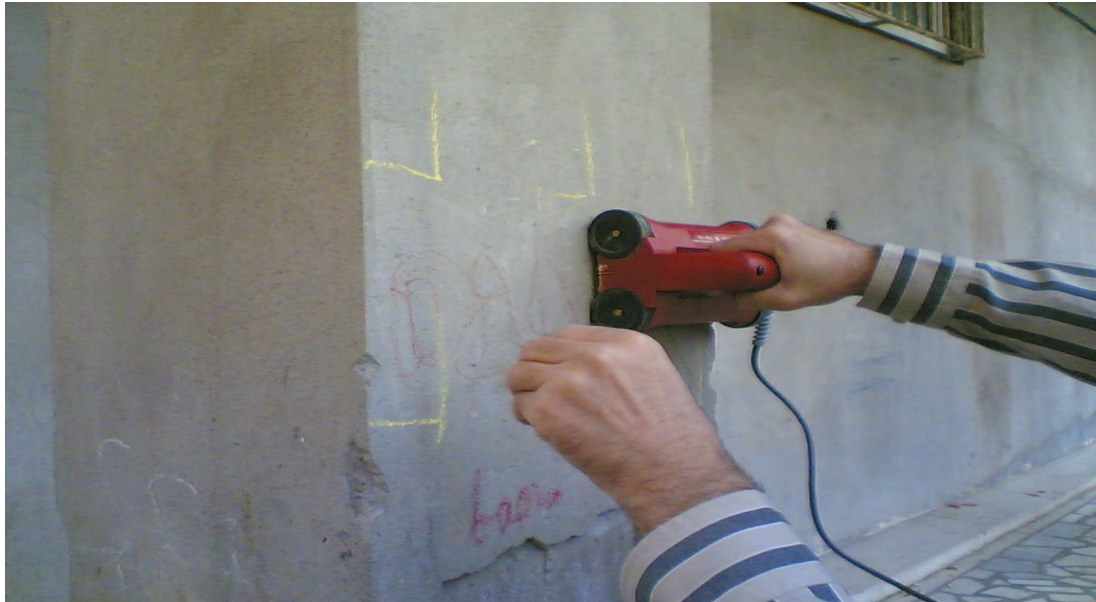
Şekil 7.5. Ferroscan Cihazı İle Donatı Tepiti Yapılması
