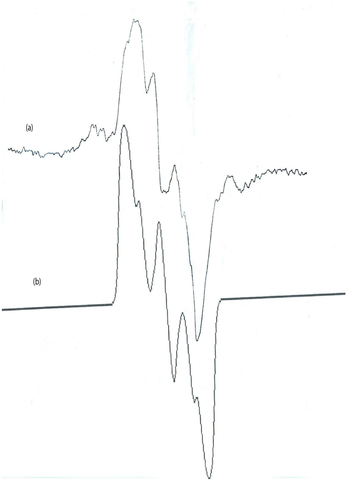
Şekil 6.2.4 L-Glutamil-L-Valin toz kristalinin EPR spektrumu
