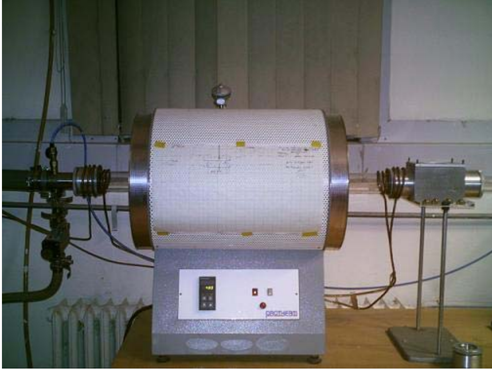
Şekil 3.23. Tavlama işlemlerinin gerçekleştirildiği fırın
