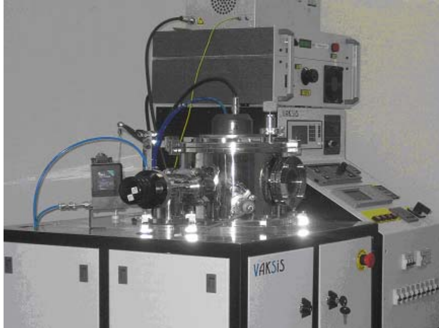
Şekil 3.22. Au püskürtme işleminin gerçekleştirildiği vakum sistemi
