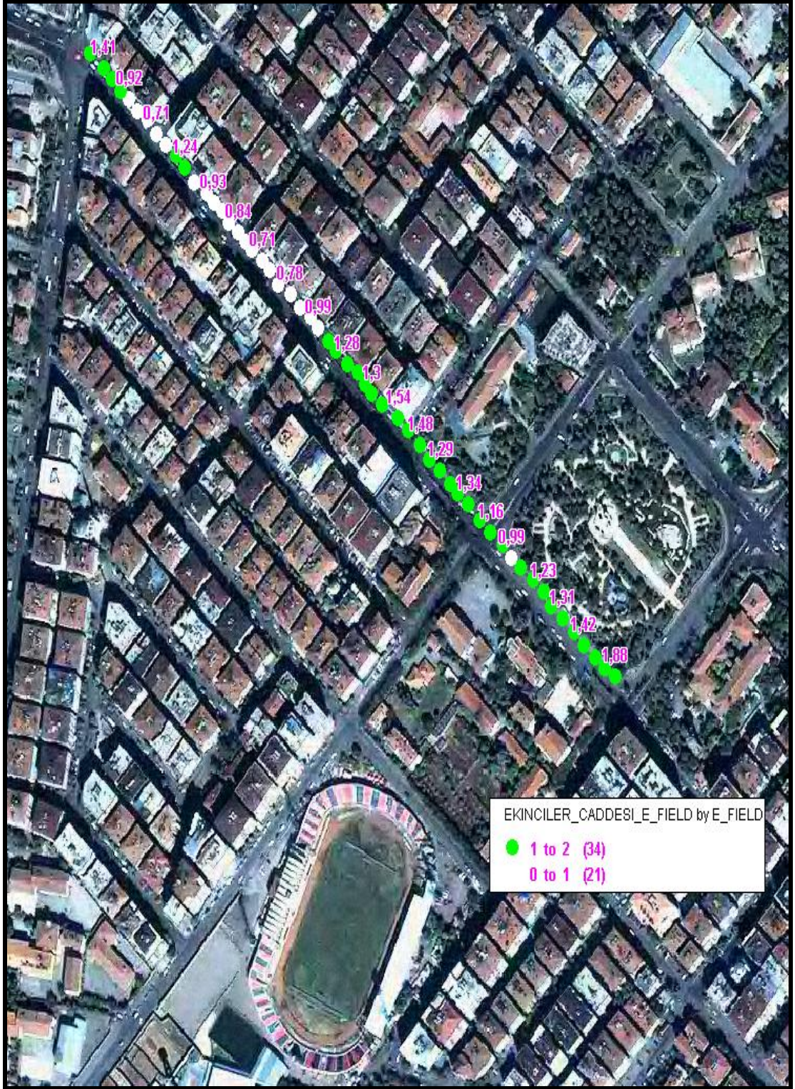
Şekil 4.12. 100 Khz-3 Ghz frekans bandında Ekinciler Caddesinde Manuel Yöntem ile ölçümü alınmış elektromanyetik alan haritası.
