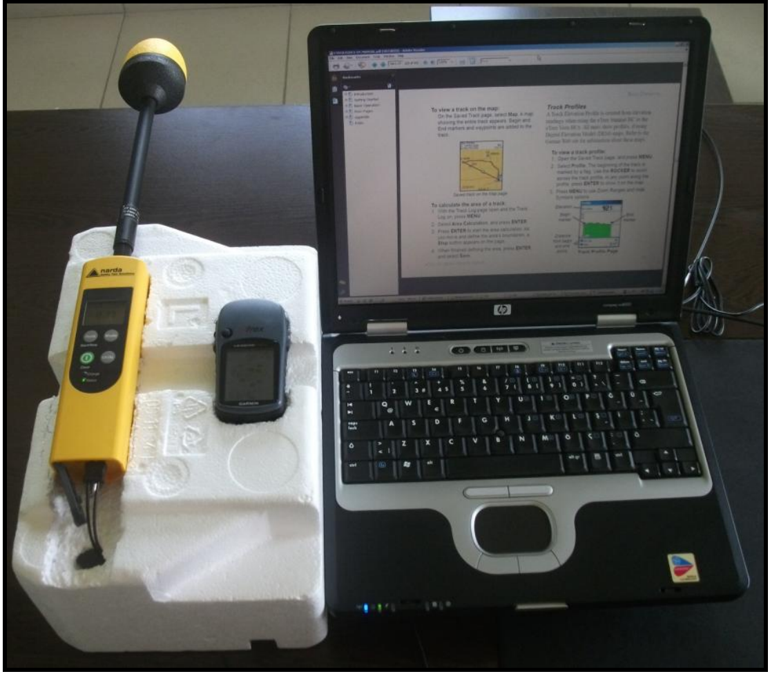
Şekil 3.7. Drive Test Yöntemi ile ölçüm almak için arabaya yerleştirilen düzenek
