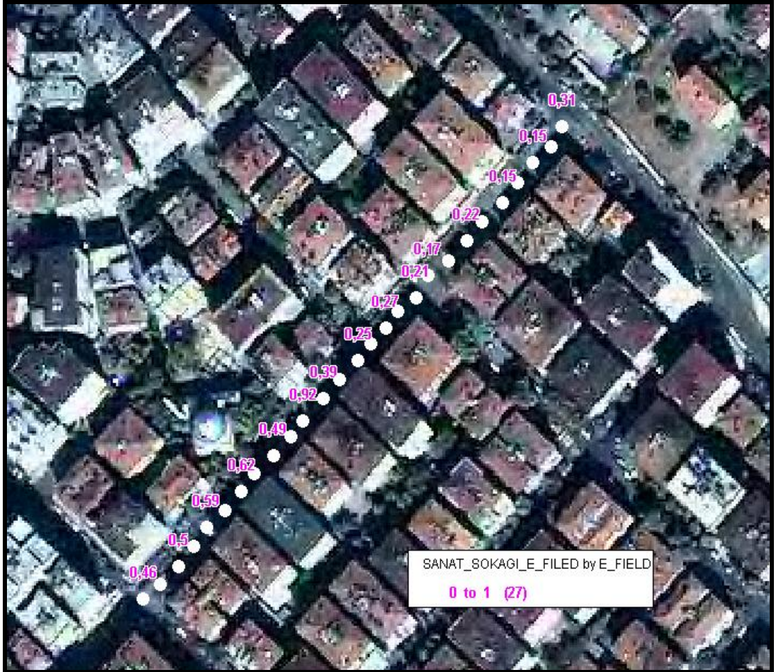
Şekil 4.11. 100 Khz-3 Ghz frekans bandında Sanat Sokağının Manuel Yöntem ile ölçümü alınmış elektromanyetik alan haritası.
