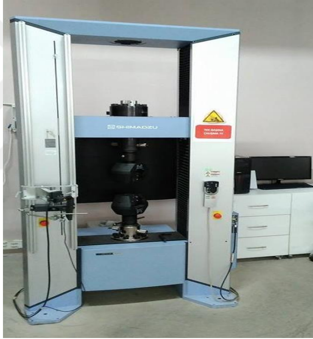
Şekil 2.4 : Shimadzu üniversal çekme testi cihazı.
