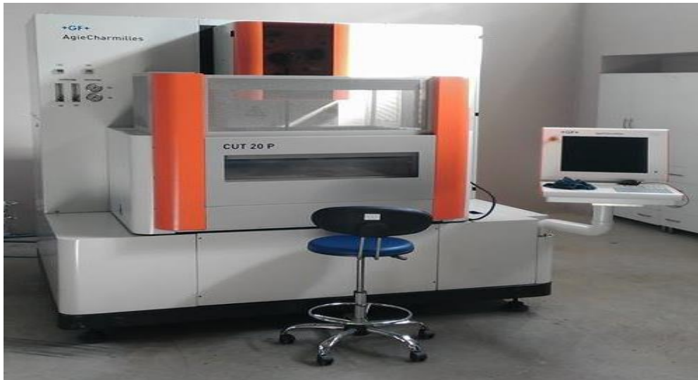
Şekil 2.6 : Agie Charmilles CUT 20P tel erozyon tezgahı (Bursa Teknik Üniversitesi Makine Mühendisliği Laboratuvarı).
