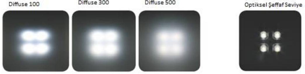
Şekil 2.2 Işık dağıtıcı özellikli malzemelerin karşılaştırmasını gösteren görsel
