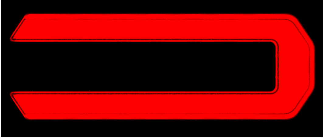
Şekil 4.32 Kuşlamalı Diffuse301 gerçek renk ışık yayılım görüntüsü
