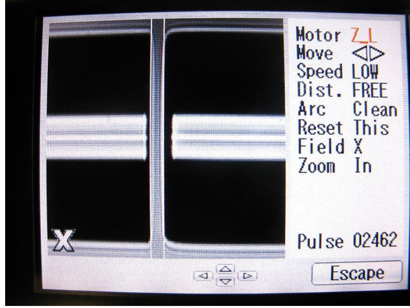
Şekil 3.17: Kaynatma (splice) öncesi düzgün olarak, sıfır derece (0°) ile, kesilmiş ve hizalanmış fiber kablolar
