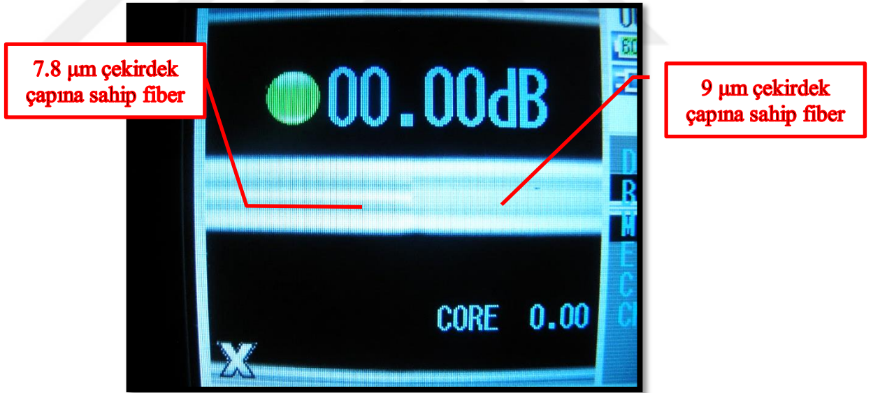
Şekil 4.27: farklı çekirdek çaplarına sahip iki fiberin kaynaklandırma (splice) görseli
