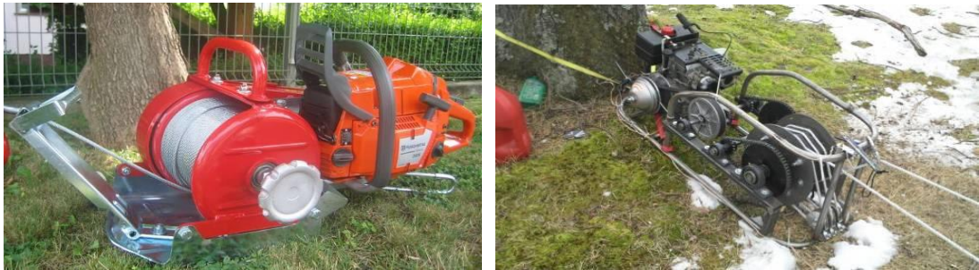
řekil 1.6 : ACKJA KBF 422 kablo vin (sol) ve Radiotır kablo vin (sađ)
