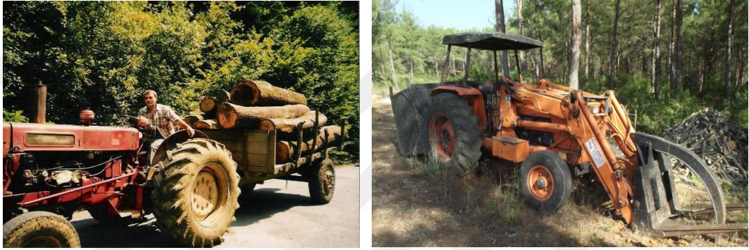
Şekil 1.4 : Tarım traktörlerinin yükleyici (sağ) ve taşıyıcı (sol) olarak kullanılması Öztürk, T., Akay, A. E.
