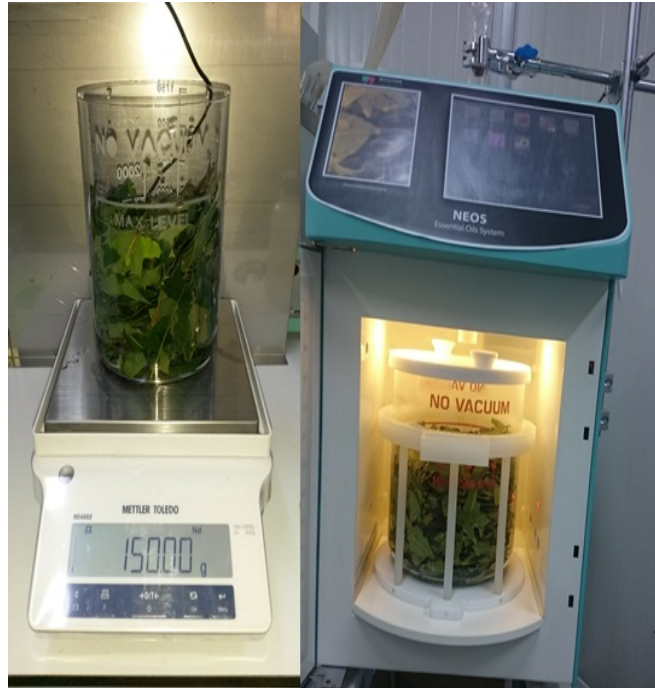
Şekil 3.10 : Defne yapraklarının tartımı ve mikrodalga destekli ekstraksiyonu.
