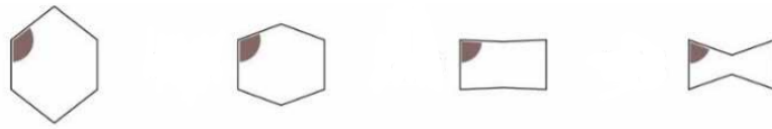
Şekil 2.5 : Açılı değerinin değişmesiyle ortaya çıkan auxetic yapı
