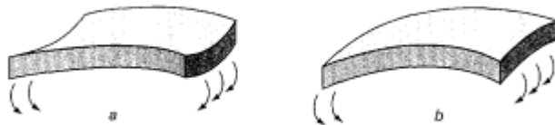
Şekil 2.16 : (a) Antiklastik davranış, (b) sinklastik davranış [35]
