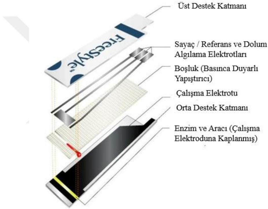
Şekil 2.8 : Test şeritlerinin katmanları [25]
