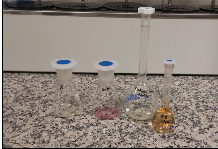
Şekil 3.8 : Butanol – HCl yöntemi ile kondanse tanen tayini
