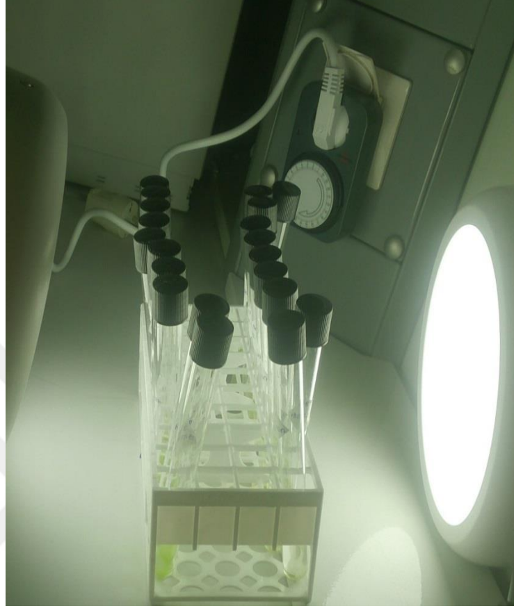
Şekil 3.23 : Tez çalışmasında kullanılan mikroalg suşlarının renk değişimlerini saptamak amacıyla oluşturulan ışık deneyi düzeni.
