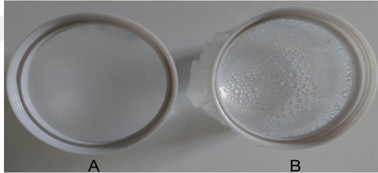
Şekil 2.7 : Su buharı geçirgenliği testleri (A-Üretilen PU-0 membran, B-Ticari polietilen film).
