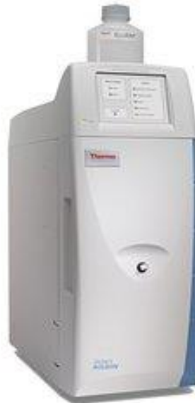
Şekil 3.4 : ICS 1100 iyon kromatografi
