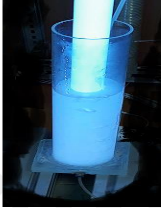
Şekil 3.3 : Kabarcıklı kolon reaktör
