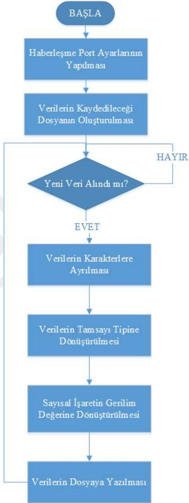
Şekil 4.12 : Merkezi birim yazılımı akış şeması
