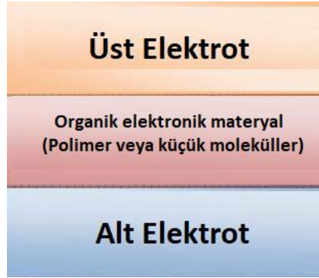
Şekil 1.8 : Tek katmanlı organik güneş pili yapısının şematik gösterimi (Güneş, 2007)
