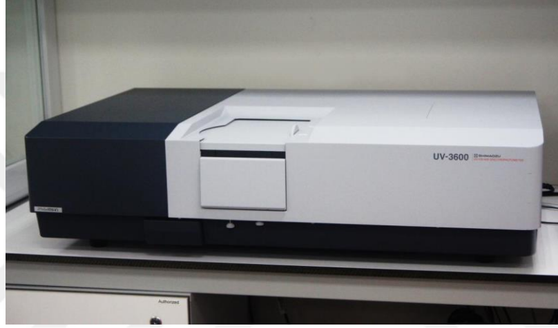
Şekil 3. 6 : Optik özelliklerin karakterizasyonunda kullanılan UV-Vis cihazı
