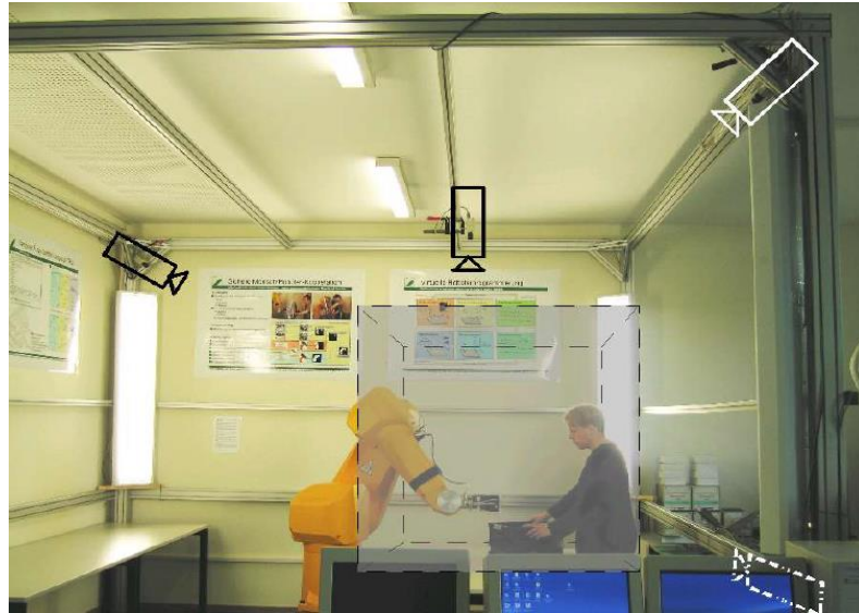
Şekil 2.2 : Parça taşımayı sağlayan hibrit sistem [10]
