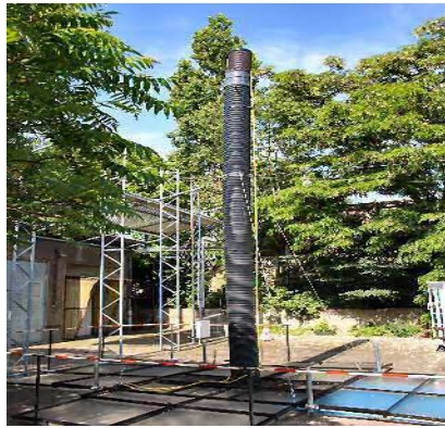
Şekil 2.5. Berlin Teknik ve Ekonomi Yüksek Okulu' nda kurulan güneş bacası sistemi.
