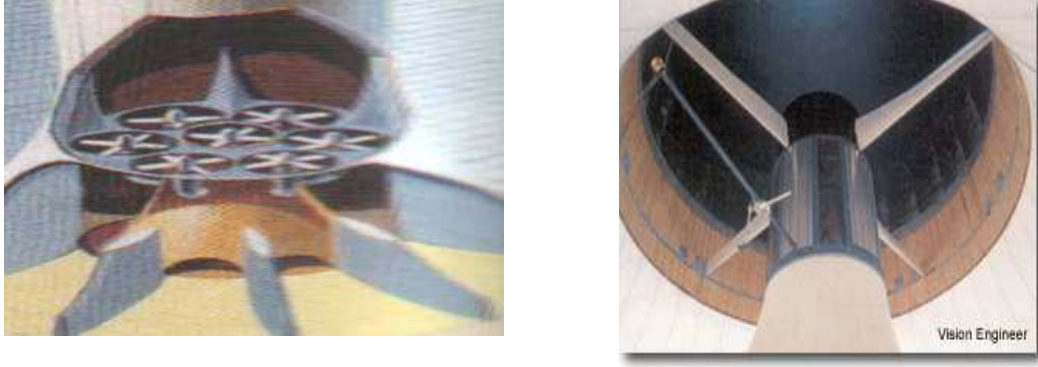
Şekil 1.15. Baca girişindeki türbin örnekleri (Vision Engineer, 2008).
