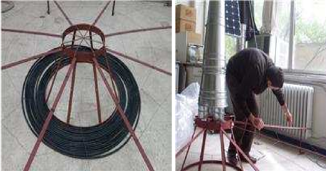
Şekil 3.1. Sera alanının biçimlendirilmesi ve baca kollektör alanının kurulumu.
