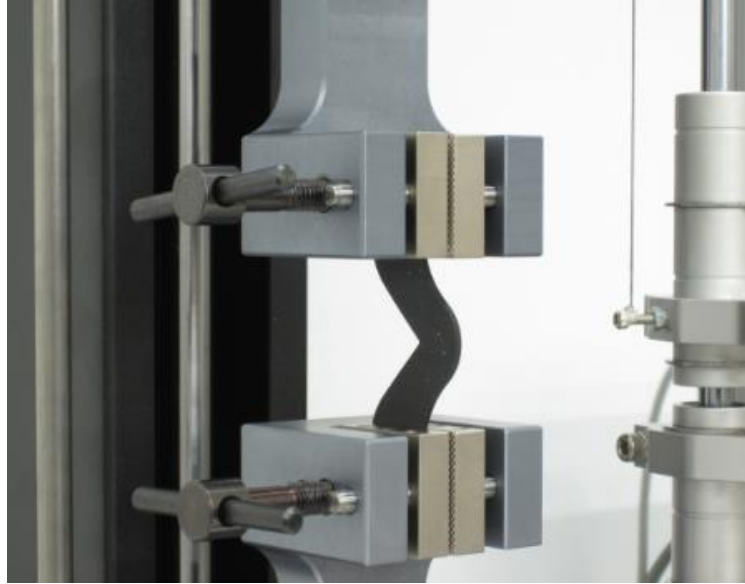
Őekil 3.19 : Yırtılma mukavemeti test dŐzeneęi
