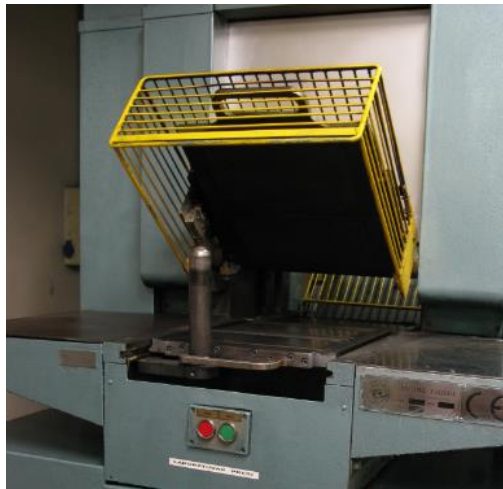
Şekil 3.15 : Test plakalarının hazırlandığı laboratuvar tipi pres
