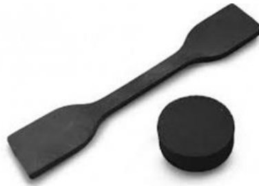
Őekil 3.16 : ekme ve kopma testinde kullanılan test parası
