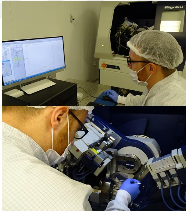
Şekil 3.15: Ermaksan Optoelektronik AR-GE Merkezi temiz odasında kurulu olan Rigaku Smartlab XRD ölçüm sistemi
