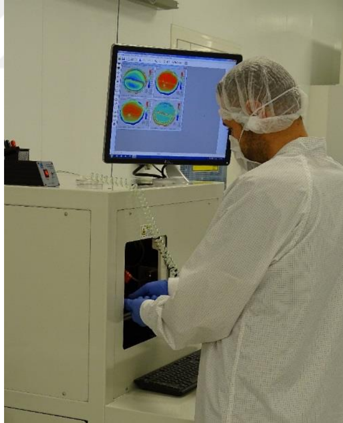
Őekil 3.18: Nanometrics RPM Blue fotol6minesans haritalama sistemi
