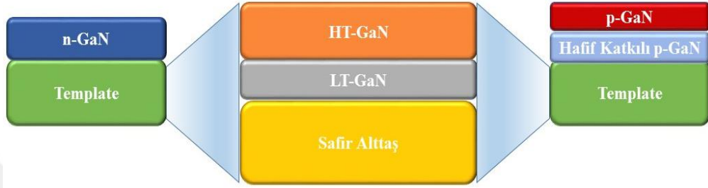
Şekil 3.31: Template GaN yapısı ve üzerine büyütülen n ve p katkılı GaN yapıları
