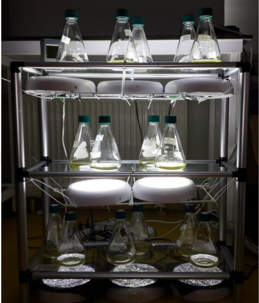
Şekil 3.1 : Dunaliella suşlarının yüksek ve düşük ışık yoğunluğunda kültürünü sağlayan deney düzeneği
