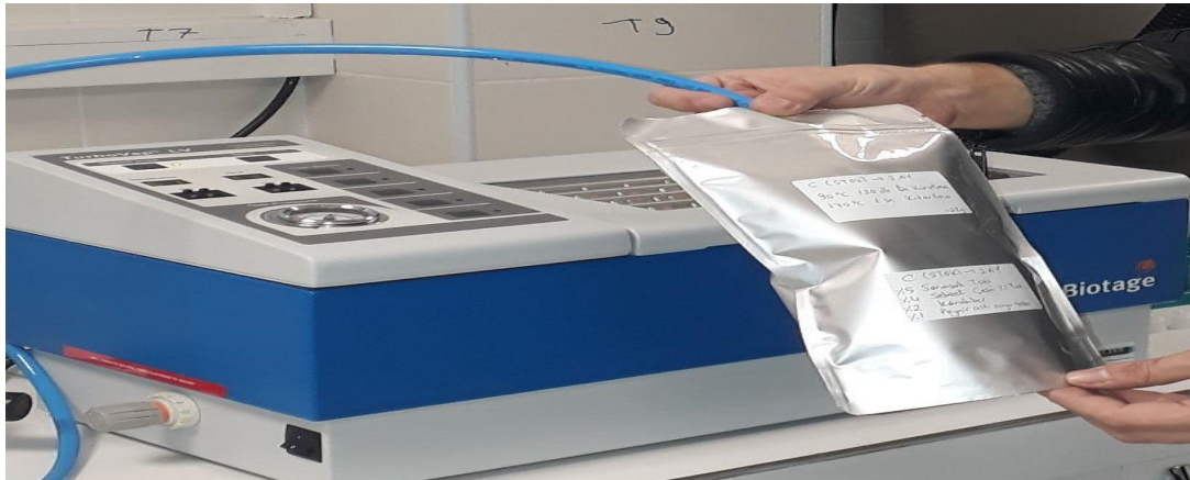
Şekil 3.2 : Kontrollü koşullar altında gerçekleştirilen azot gazı dolum işlemi
