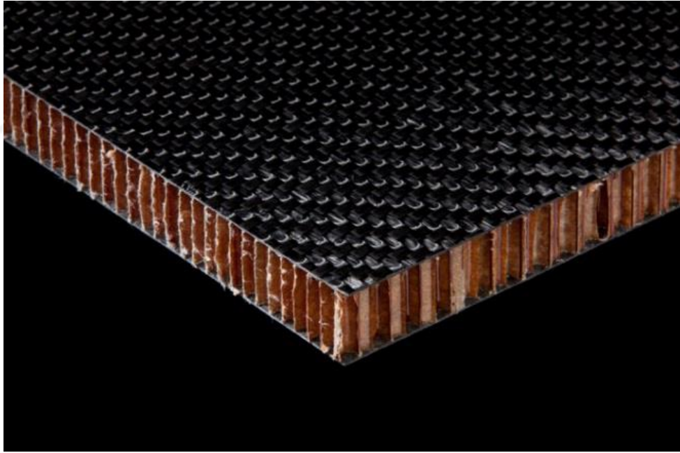
Şekil 1.10 : Karbon fiber sandviç petek panel(aerospaceengineeringblog.com, Temmuz 2018)
