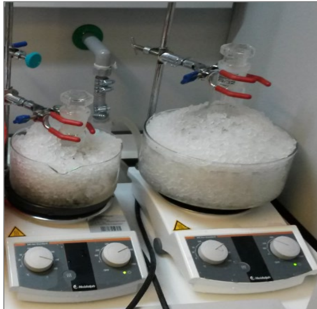
Şekil 3.2: Tosilasyon reaksiyon işlemi
