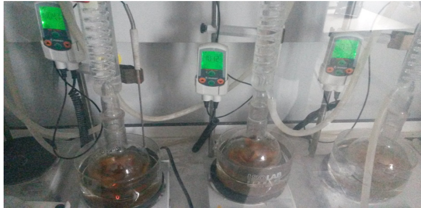
Şekil 3.5: Polikaprolakton reaksiyon işlemi
