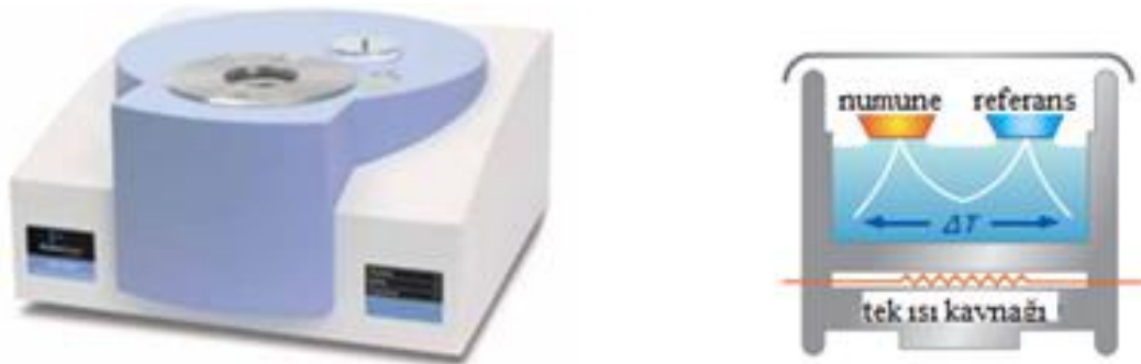
Şekil 3.6 : DSC cihazı ve cihazın iç görüntüsü
