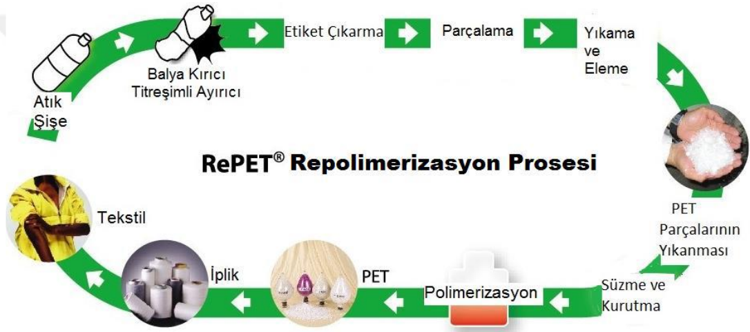
Şekil 2.21 : PET ambalajın geri dönüşüm prosesi (PET Recycled Process, (t.y.))
