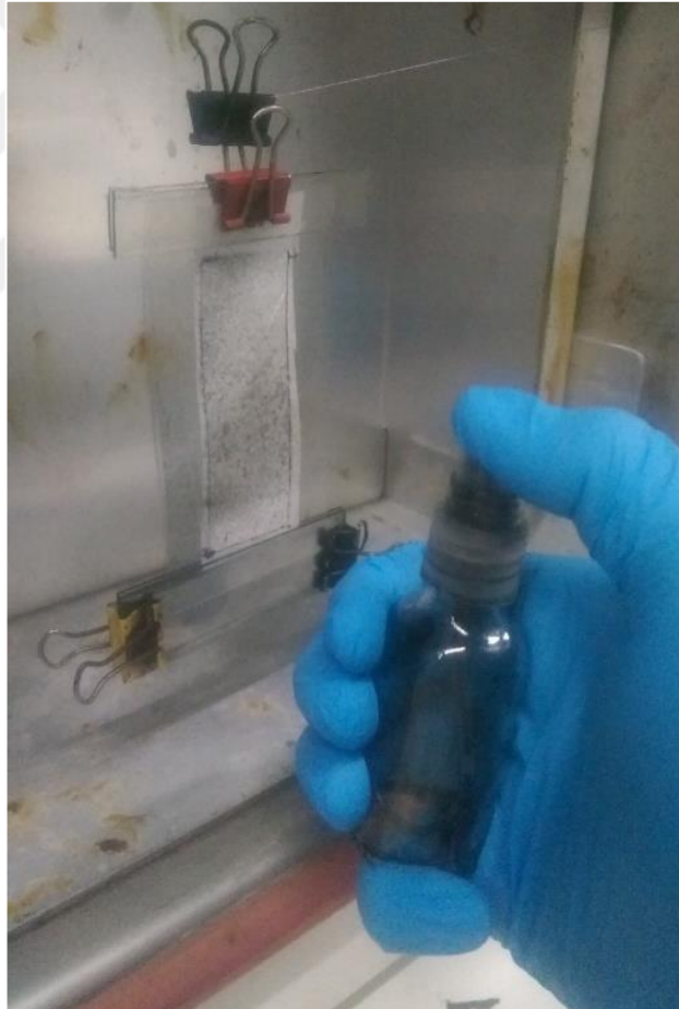
Şekil 2.1: Katkısız nanolifin rGO kaplanması işlemini gösteren bir fotoğraf
