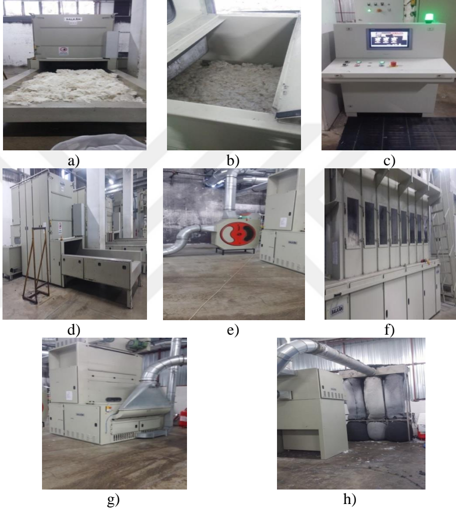
Şekil 3.16 : OE-Rotor iplik üretiminin gerçekleştirildiği ait harman hallaç dairesi: a) balya açıcı, b) balya açıcı çıkışı, c) balya açıcı ayar monitörü, d) balya açıcı, e) mıknatıslı metal parça seperatörü, f) unimix elyaf karıştırıcı, g) ince temizleme, h) tarak makinesine sevk bölümü
