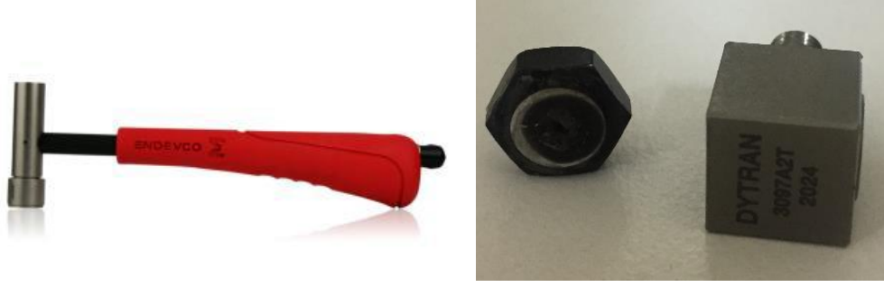
Şekil 6.5 : Darbe çekici, ivmeölçer ve altlığı
