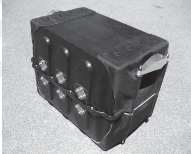
Şekil 2.6: Polimer kompozit batarya paketi [12].
