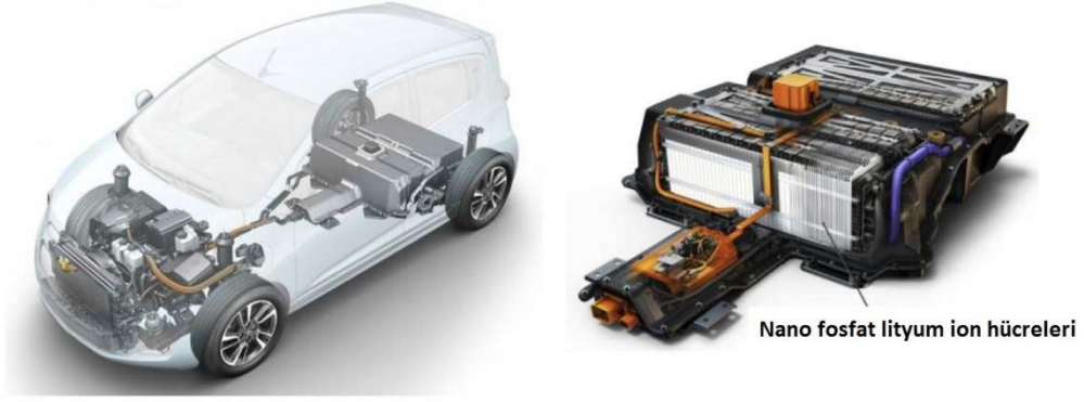
Şekil 2.4: Elektrikli otomobillerde kullanılan batarya paketi [9].
