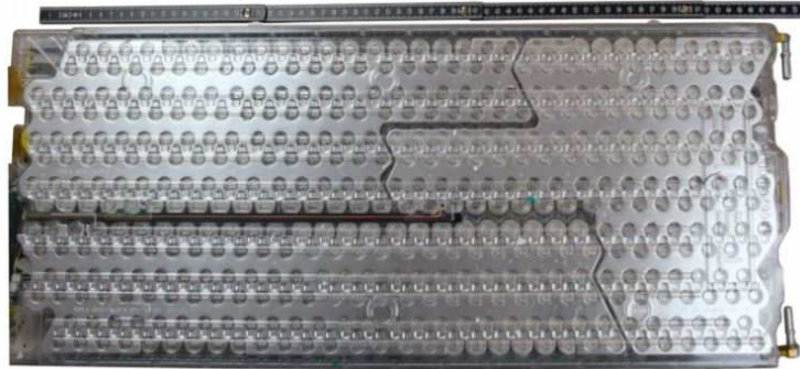
Şekil 2.5: Tesla Model S batarya paketi [11].
