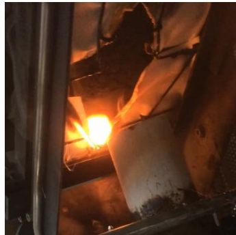
Şekil 5.8: Polyester kumaşa kaplanmış PU-100 NFP 503 testi test sonu görüntüsü
