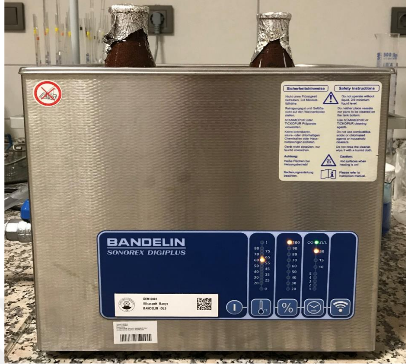
Şekil 4.5: Ultrasonik banyoda ekstraksiyon işlemi.
