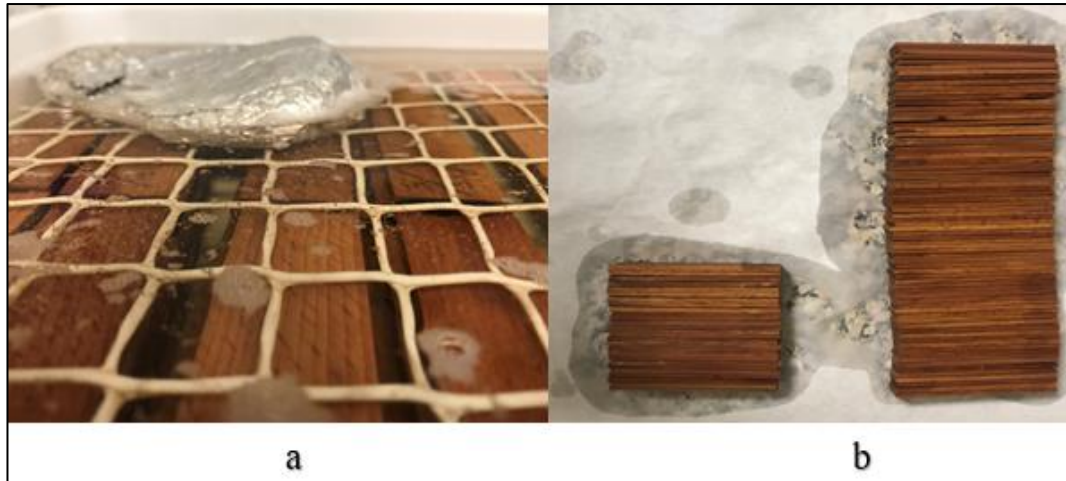
Şekil 4.14: a) Islak dayanım için suda bekleme aşaması b) Örneklerin fazla sudan arındırılma aşaması.
