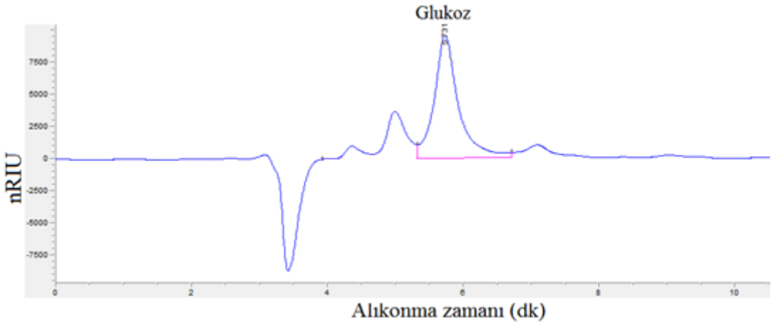
Şekil C.51 : Aseton-su (3:1 v/v) çözücü ortamında selüloz hidrolizi sonrası glukoz içeriğini gösteren HPLC kromatogramı.
