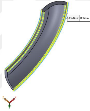
Şekil 4.24 : 0,5 mm radyus uygulanan köşeler.
