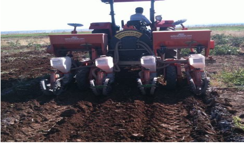
Şekil 3.5. Denemede kullanılan pnömomatik ekim makinesi
