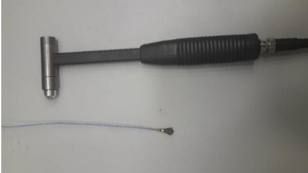
Şekil 3.8 : Deneyde kullanılan modal darbe çekici ve ivmeölçer.
