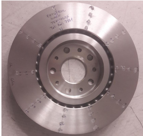
Şekil 3.10 : Ölçüm noktaları işaretlenmiş fren diski.
