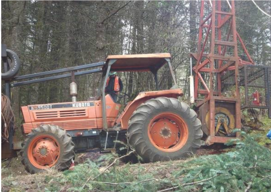
Şekil 1.6: Tarım traktörüne monte edilen Koller K300 vinçli hava hattı (Sert, 2014)
