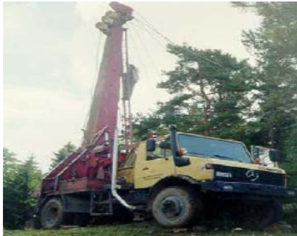
Şekil 1.18: URUS M-III orta mesafeli mobil vinçli hava hattı
