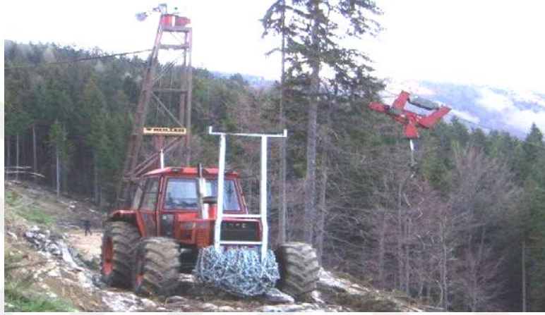
Şekil 1.17: Koller K300 kısa mesafeli mobil vinçli hava hattı
