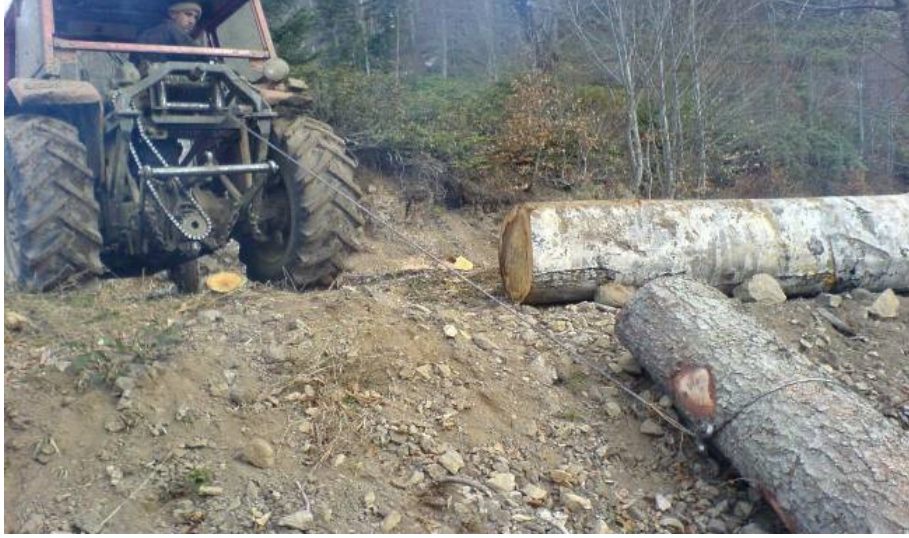
Şekil 1.3 : Tarım traktörünün kablo çekimiyle orman ürünlerini çekmesi (Andiç, 2018)
