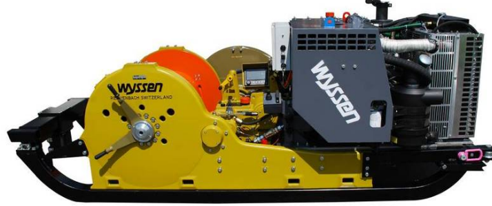
Şekil 1.19: WYSSSEN marka uzun mesafeli vinçli hava hattı kızağı ve motor
