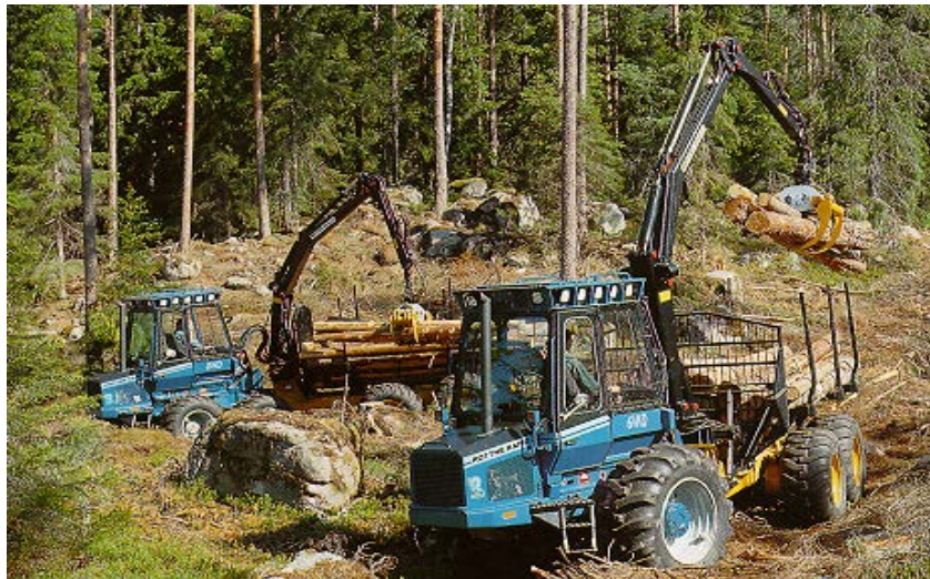
Şekil 1.11: Lastik tekerlekli taşıyıcı (Akay ve Yenilmez, 2008)
