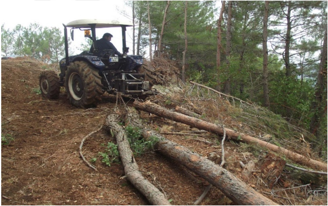
Şekil 1.2: Tarım traktörünün orman ürünlerini rampaya sürütmesi (Andiç, 2018)
