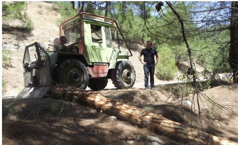
Şekil 1.7: Orman traktörüyle bölmeden çıkarma (Sert, 2014)
