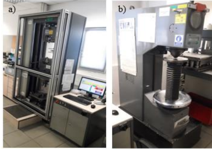
Şekil 3.1 : Mekanik testler (a) çekme testi, (b) sertlik testi.
