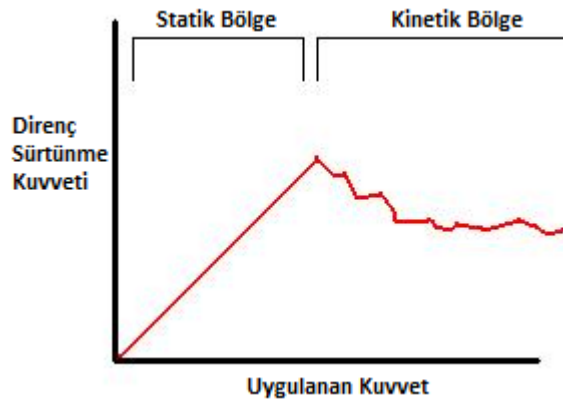
Şekil 2.1 : Kuvvet-Sürtünme eğrisinde statik ve kinetik sürtünme bölgeleri [78].
